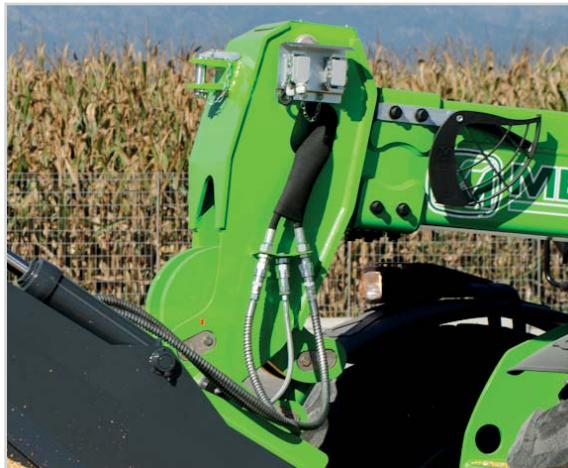
Rohre, Elektrokabel und zusätzliche Hydraulikleitungen sind im Inneren des Teleskoparms untergebracht
