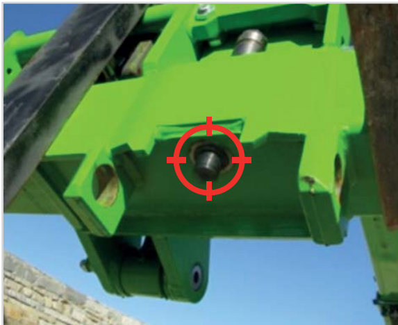
Tac-Lock: hydraulische Befestigung der Anbaugeräte direkt von der Kabine
