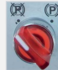
Manueller Wahlschalter der Feststellbremse, die sich automatisch beim Abstellen des Motors einschaltet
