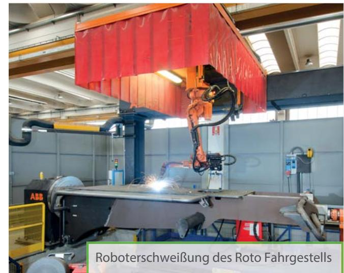
Roboterschweißung des Roto Fahrgestells
