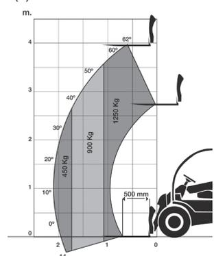
(\*\*) Universal / EURO 8 Aufnahme (in Verbindung mit Seitenschieber Ladegewichtsreduktion)
