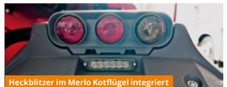
Heckblitzer im Merlo Kotflügel integriert
