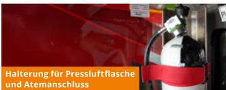
Halterung für Pressluftflasche und Atemanschluss
